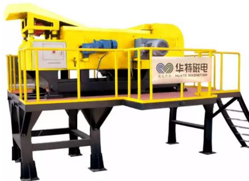
Figura 13 – Equipamento de separação de metais por correntes Foucault (ou Eddy current ) (Imagem retirada do site de vendas Alibaba).
