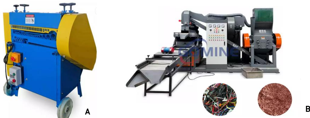
Figura 8 – A - Equipamento semiautomático de descarnamento dos cabos; B - Linha de descarnamento e separação dos cabos (Imagens retiradas do site de vendas Alibaba).
