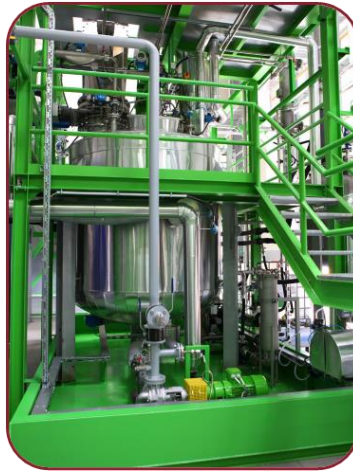
Figura 27- Reator de glicólise utilizado na operação H&S. Fonte: HS-Anlagentechnik. Recycling reactors for rigid PU foam residues (HS-Anlagentechnik, n.a). Reator de glicólise utilizado na operação H&S (HS-Anlagentechnik, n.a).
