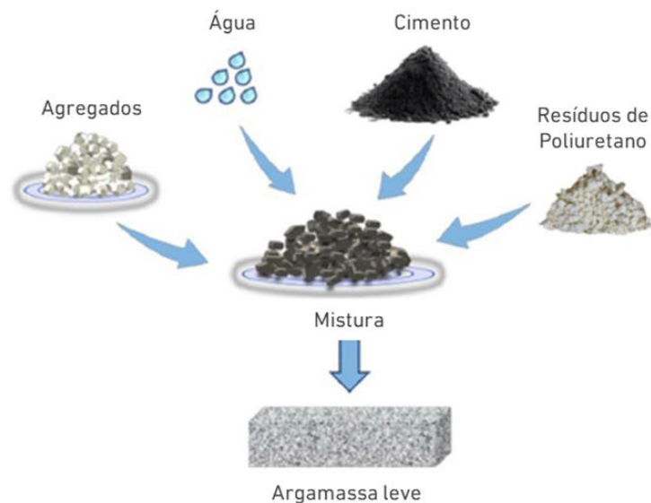
Figura 9 - Esquema da composição de argamassa leve.
