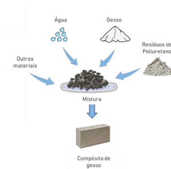
Figura 12- Esquema da composição de compósitos de gesso.
